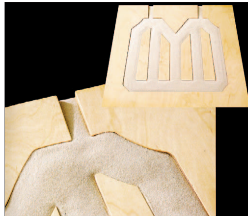
Die Tragflächen der Tonbasen weisen Leerräume auf, die je nach Bedarf mit Quarzsand oder Bleischrot gefüllt werden.
